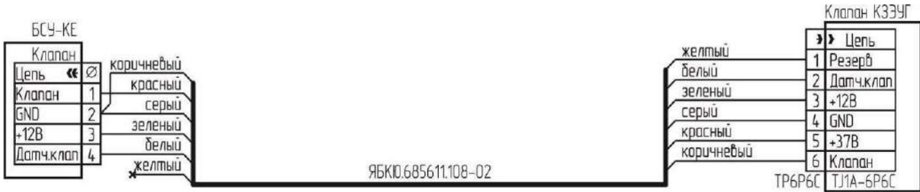
Рисунок Г.4 – Типовая схема подключения клапана КЗЭУГ с разъемом TJ1A-6P6C
