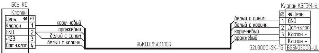
Рисунок Г.3 – Типовая схема подключения клапана КЗГЭМ-У с разъемом BG5N03000-UL
